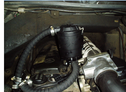
CCV3551KIT01 installed on a Mercedes Sprinter Van.
